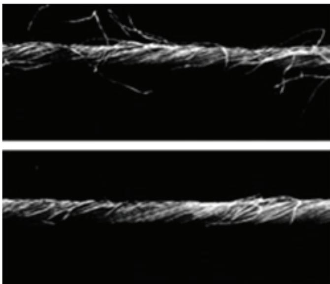
Nas imagens abaixo, podemos observar a diferença na quantidade de filamento de um fio multifilamento (esquerda) em relação ao um fio de Poliéster baixa filamentagem (direita).
